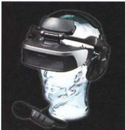
Il casco della Sony utilizzato nell'applicazione è il Sony Glasstron. Esso utilizza due LCD da 0,7 pollici ciascuno con 180.000 pixel. Si collega alla porta VGA del computer mediante un convertitore NTSC to VGA.
